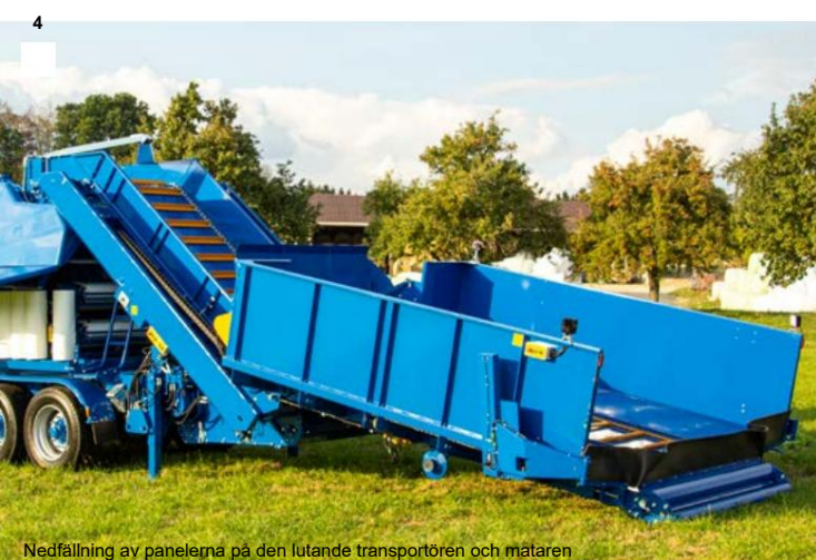
4 Nedfällning av panelerna på den lutande transportören och mataren
