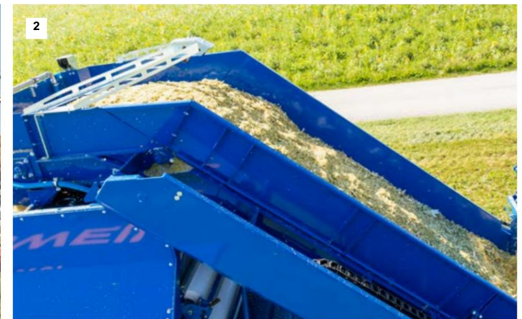
2 Materialet mäts perfekt och transporteras från mataren till den lutande transportören
