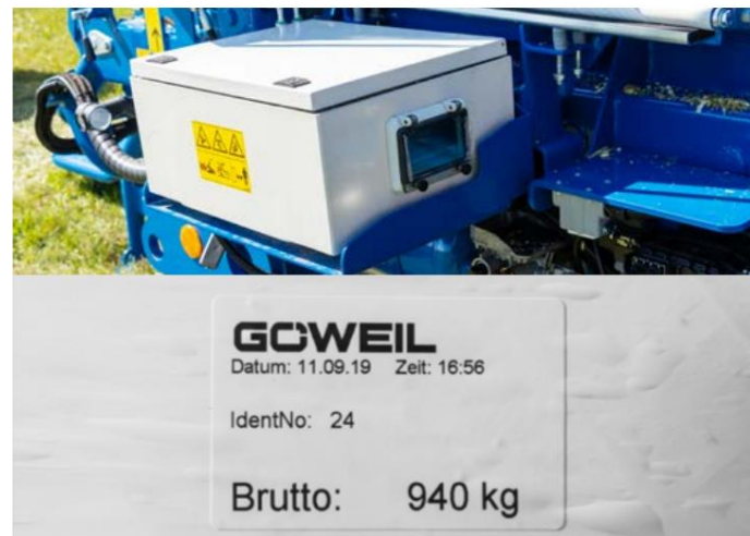
Etikettskrivare (överst) och självhäftande etikett på rundbalen (nederst)
