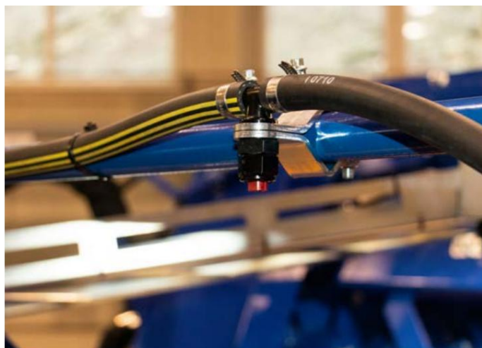
Två munstycken med 0,1 rostfritt stål design
