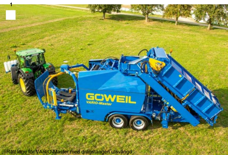
1 Rätt läge för VARIO-Master med dragstangen utsvängd
